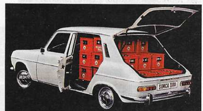
Quermotor, Frontantrieb und große Klappe: Das Konzept des 1100 war anno 1967 wegweisend
